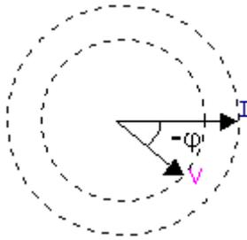
LA TENSIÓN EN EXTREMOS DE UN CIRCUITO **RC** ESTÁ RETRASADA  $-\varphi$  ° RESPECTO A LA INTENSIDAD QUE CIRCULA POR ÉL, SIENDO  $-90^\circ < -\varphi < 0^\circ$
