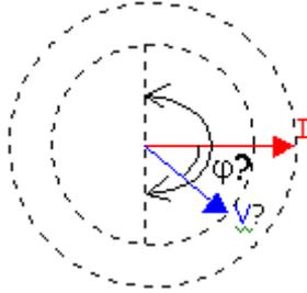
LA TENSIÓN EN EXTREMOS DE UN CIRCUITO RLC ESTÁ DEFASADA  $\varphi$  ° RESPECTO A LA INTENSIDAD QUE CIRCULA POR ÉL, SIENDO  $-90^\circ < \varphi < 90^\circ$
