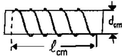
Podemos calcular el valor aproximado del coeficiente de autoinducción de la bobina en el caso de que su núcleo sea de aire mediante la expresión:
