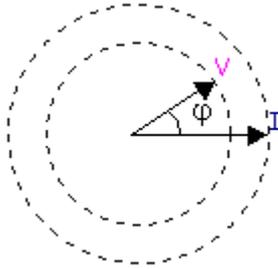
LA TENSIÓN EN EXTREMOS DE UN CIRCUITO RL ESTÁ ADELANTADA  $\varphi^\circ$  RESPECTO A LA INTENSIDAD QUE CIRCULA POR ÉL, SIENDO  $0^\circ < \varphi < 90^\circ$
